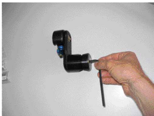
Dévissez les deux écrous de l'étau.
